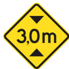
A-37 Altura limitada
