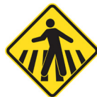
A-32b Passagem sinalizada de pedestres
