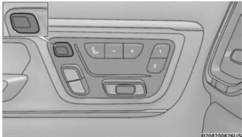
**Interruptor de ajuste do encosto de cabeça elétrico de quatro vias**
