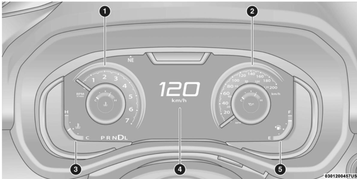
Pressione o botão **OK** nos controles do Visor do Painel de Instrumentos localizados no volante para alterar a exibição de Analógico para Digital.
